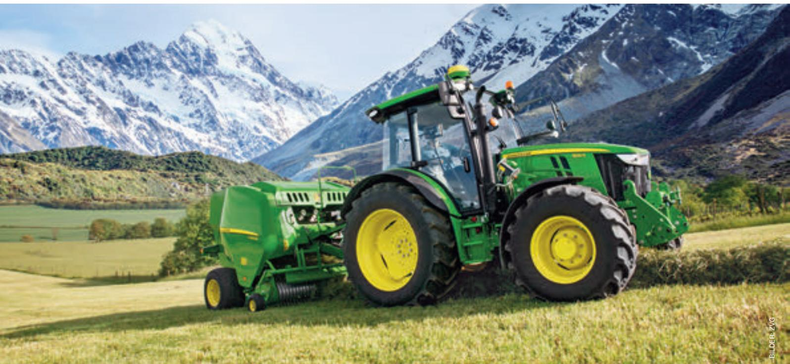
Nach dem Schwaden ist zeitnahes Pressen beziehungsweise Befüllen der Silos wichtig. Im Bild: Rundballenpresse
