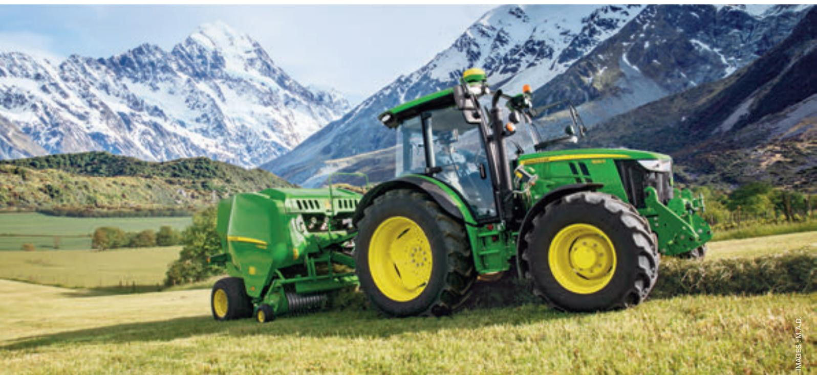
Après l'andainage, il est important de presser les balles ou de remplir les silos rapidement. Sur la photo : presse à balles rondes
