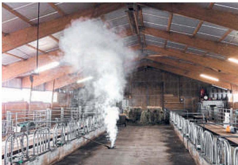
Rauchtest zur Untersuchung der Luftbewegungen in einem Viehstall.
