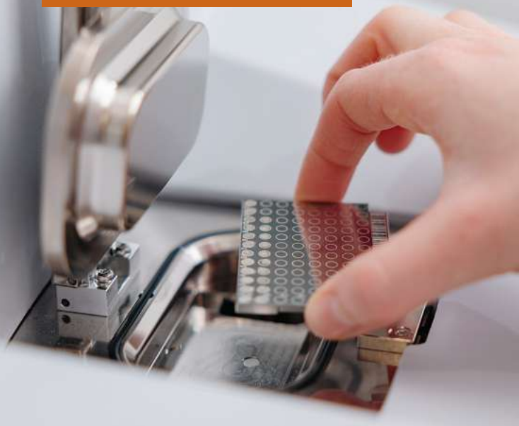
Einlegen der Trägerplatte in den MALDI-TOF
